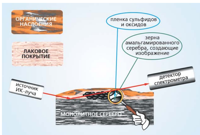
Схема ИК-спектроскопии зеркального отражения.
