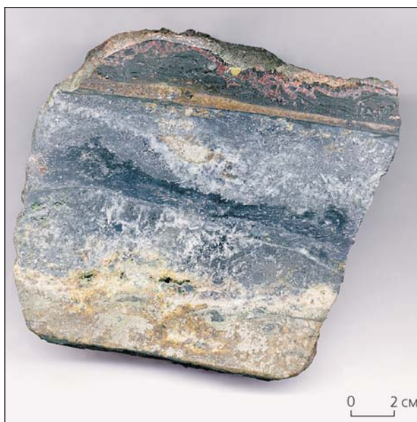
Мангазейское месторождение. Слева — галенит-тетраэдритовая серебряная руда. В верхней части образца — развальцованный галенит (PbS), в нижней — серебросодержащий тетраэдрит. Справа — серебряно-сульфидная руда. В верхней части образца — гематит-сфалеритовая минеральная ассоциация, в центре жилы — серебро-кварц-галенитовая и внизу — сидерит-пиритовая. Коллекция М.М.Константинова.
